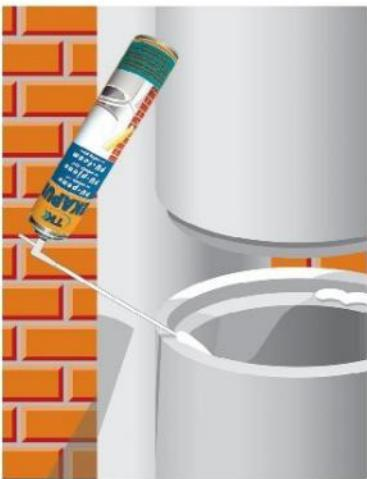
ТЕКАПУР пена монтажная для соединения труб – однокомпонентная полиуретановая пена, затвердевающая под воздействием атмосферной влаги.
