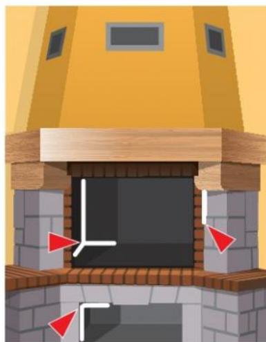
Tekadom 1200°C – однокомпонентная огнестойкая уплотнительная масса на основе неорганических силикатов. Применяется для быстрого ремонта каминов, печей, дымоходов, огнестойкого кирпича
