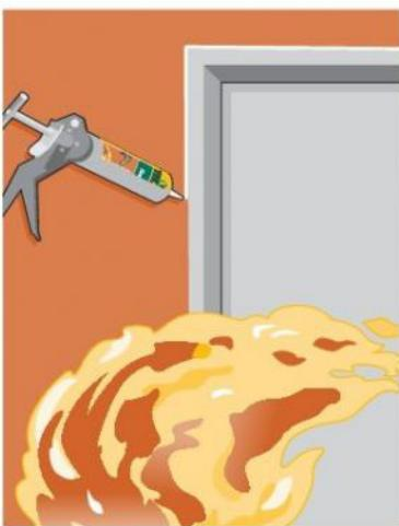
Tekasil Firestop – нейтральная однокомпонентная уплотнительная масса, применяющаяся для уплотнения швов в местах где в случае пожара необходимо защищать помещения от проникновения огня, дыма, ядовитых газов и воды.
