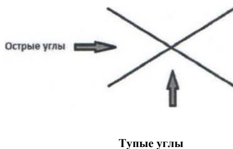
Рисунок 1. схема Х-образного надреза
