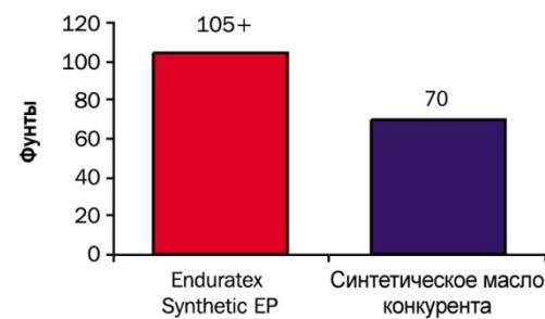
Испытание на нагрузки OK на машине трения Тимкена (ASTM D2782) показывает изменение свойств редукторных масел при повышенных нагрузках и давлении. На данной диаграмме ясно видно, что масла ENDURATEX™ Synthetic EP обладают лучшими свойствами по сравнению с аналогами конкурирующей компании.
